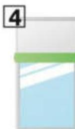
**4** Pulvériser du LPA sur le vitrage et dérouler le film côté colle vers soi.
