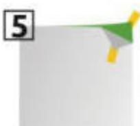
**5** Retirer le liner à l'aide de 2 morceaux de ruban adhésif et pulvériser le LPA abondamment en brouillard fin.
