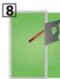
**8** Araser le film à l'aide du cutter et du guide de coupe pour laisser un joint de dilatation (1 à 2 mm).
