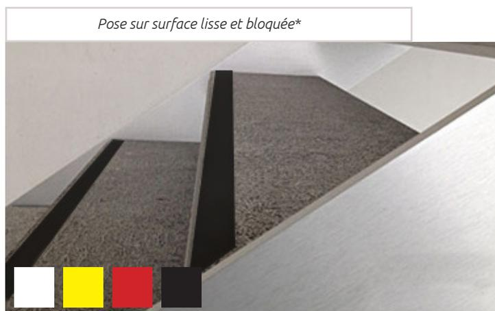
Ces bandes anti dérapantes adhésives avec grip renforcé, conviennent aux usines, et autres endroits à fort passage. Résistantes à l'eau, huiles moteurs et produits chimiques (PSTC-35). Coefficient de friction : 102TRL sec, et 71 TRL humide. Essais conforme à ASTM C 1028-96.
