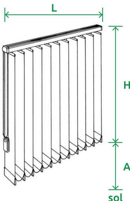
**Les dimensions à fournir :****L** : Longueur totale hors tout**H** : Hauteur totale, mécanisme et barre de charge comprise**A** : Allège, du bas du store jusqu'au sol
